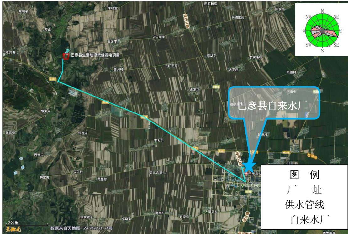
图 3-1-2 生活供水管线走向图
